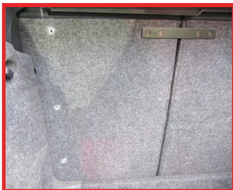
Chybějící přepážka zavazadlového prostoru
